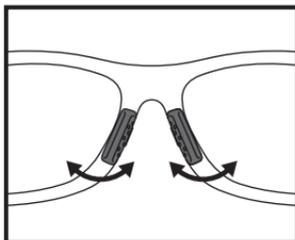
鼻幅に合わせて高さや幅が調整できます。
