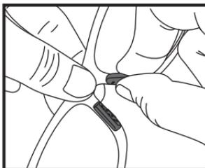
ノーズパッドを指でつまみ、左右に押し倒すようにして、段階的に動かしてください。
